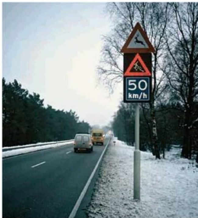
60 pav. Kelio ženklavimo ir pakelių sensorinė sistema. Įspėjamasis ir nurodomasis kelio ženklai pradeda mirksėti, kai prie kelio priartėja elniai (2 priedas [15])
