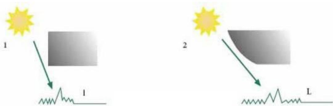
51 pav. Užlenktas tilto pagrindo kraštas padidina perėjos apšviestumą ir augalijos vystymąsi (2 priedas [21])
