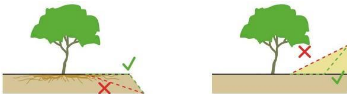
67 pav. Pasirenkant tinkamus techninius sprendinius, formuojant iškasas ir sankasas, galima išsaugoti dalį medžio šaknų (2 priedas [2])
