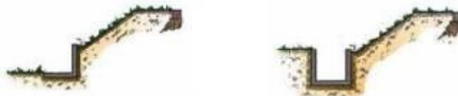
11 pav. Tvoros varliagyviams atitverti nuo kelio. Iš kairės: apkastas tvoros pagrindas, įkastas tvoros pagrindas, užlenktas tvoros viršus, užriestas tvoros viršus
