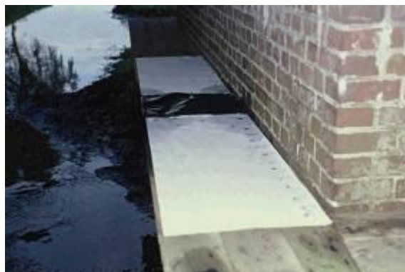
64 pav. Priemonės, fiksuojančios gyvūnų pėdsakus perėjose: kairėje – fotokamera, fiksuojanti pro daviklius praeinančius gyvūnus; dešinėje – gyvūnas, praeidamas per tušo juostą, palieka pėdsaką iš jos kraštų pritvirtintuose popieriaus lapuose (2 priedas [15])
